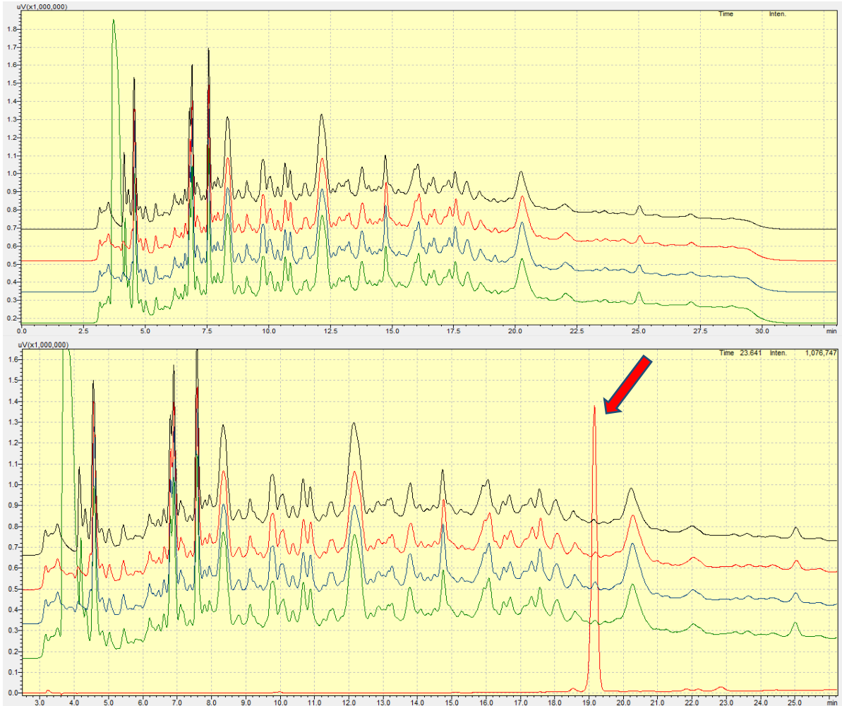
Şekil 2. HPLC Kromatogramları: Siyah: ZY1, Kırmızı: ZY2, Mavi: ZY3, Yeşil: ZY4 ve oleuropein standardının (500 ppm) karşılaştırılması. Şekildeki ok piklerden rahatlıkla ayrılarak tek bir pik halinde görülmüştür. ZY1: Distile su, ZY2: %5 Etanol, ZY3: %5 Metanol, ZY4: %1 DMSO (Dimetil sülfoksit)
